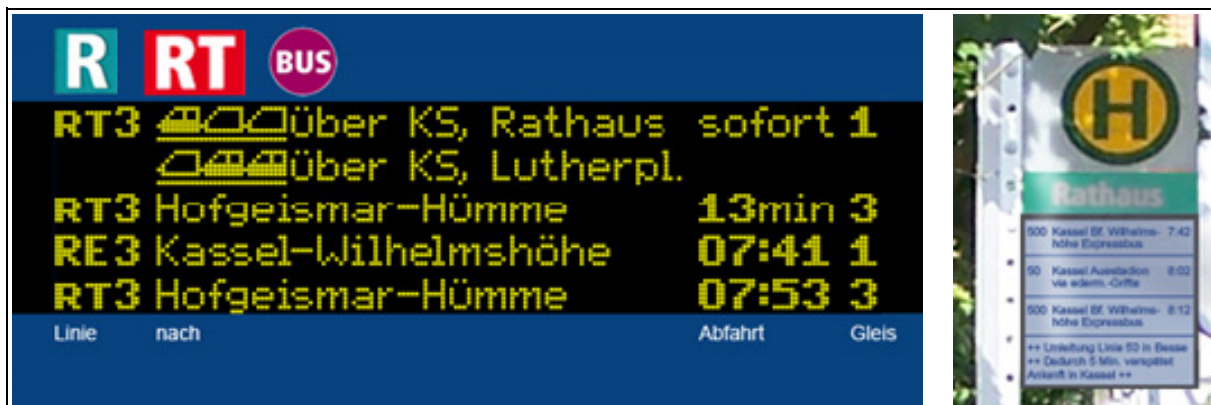
Abb. VI-8: Ausführungen von DFI-Anzeigen mit Leuchtdioden (LED; links) und Flüssigkristallen (LCD; rechts)
