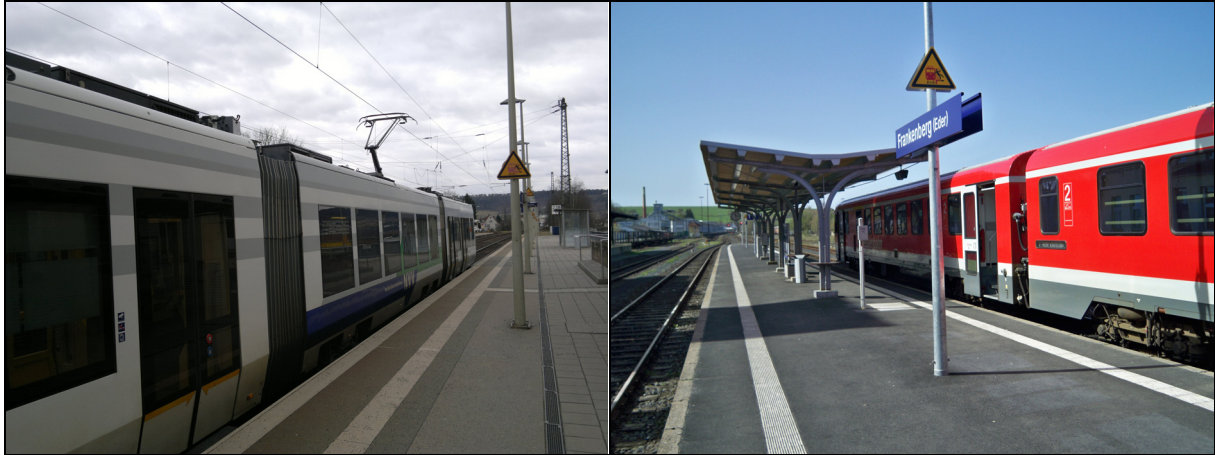
Abb. IV-10: Nicht zur RT korrespondierende Bahnsteighöhe in Melsungen (links) und Einsatz von Altbaureihen mit Trittstufen im Eingangsbereich in Frankenberg (rechts)
